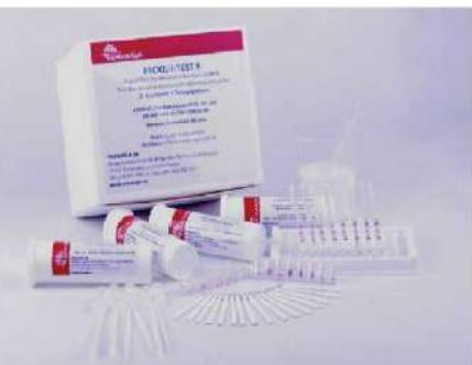
**PROQUI-TEST R** temelji se na specifičnoj antigen-antitijelo reakciji i imunokromatografiji. Ako su prisutni, antibiotici u uzorku dovode do obojene reakcije na test traci, a reakcija ovisi o koncentraciji antibiotika u uzorku.
